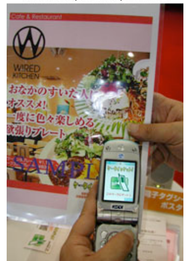
Système d'étiquettes RFID d'Okii Electric avec lecture par mobile
